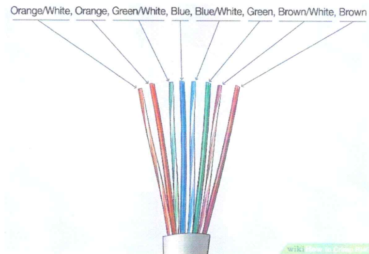
Gambar 23. Urutan kabel UTP
